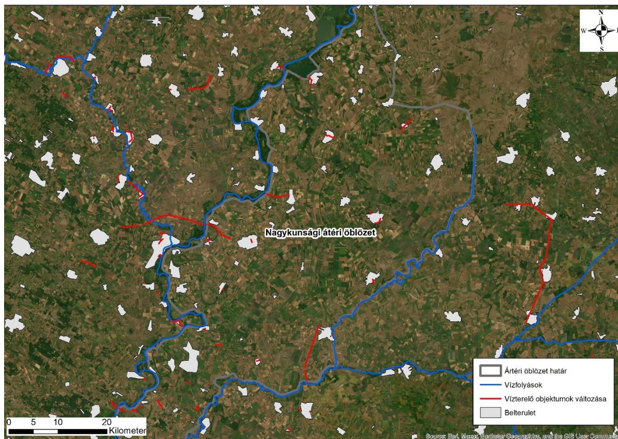
13. ábra: Vízterelő objektumok változása a Nagykunsági ártéri öblözetben
