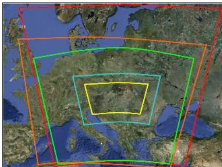
5. ábra A hazai regionális klímamodellek által alkalmazott integrálási tartomány. sárga – ALADIN, 10 km-es felbontás; kék – RegCM, 10 km; narancs – PRECIS, 25 km; zöld – REMO, 25 km; piros – ALADIN, 25 km. (BARTHOLY et al., 2011)
