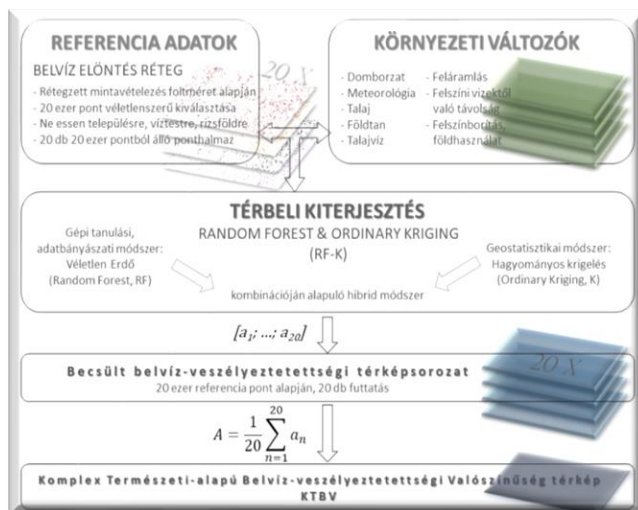
20. ábra. ábra. A belvíz-veszélyeztetettségi térképezés fejlesztett módszertanának (RF-K) folyamatábrája
