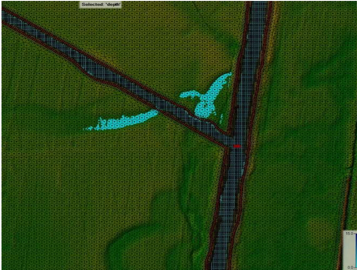
23. ábra Végeges HEC-RAS 2D modell geometriai kialakítás a Babócsai-Rinya vízfolyás esetében. A főmeder, és a töltésezett betorkolló vízfolyások medrek esetében területi rácsháló sűrítést alkalmaztunk. A magaspontok geometriába építésével sikeresen integráltuk a vízterelők előntésre gyakorolt hatását a modellekbe. A meder esetében négyyszög, az ártér esetében hatszög alakú rácshálót hoztunk létre.
