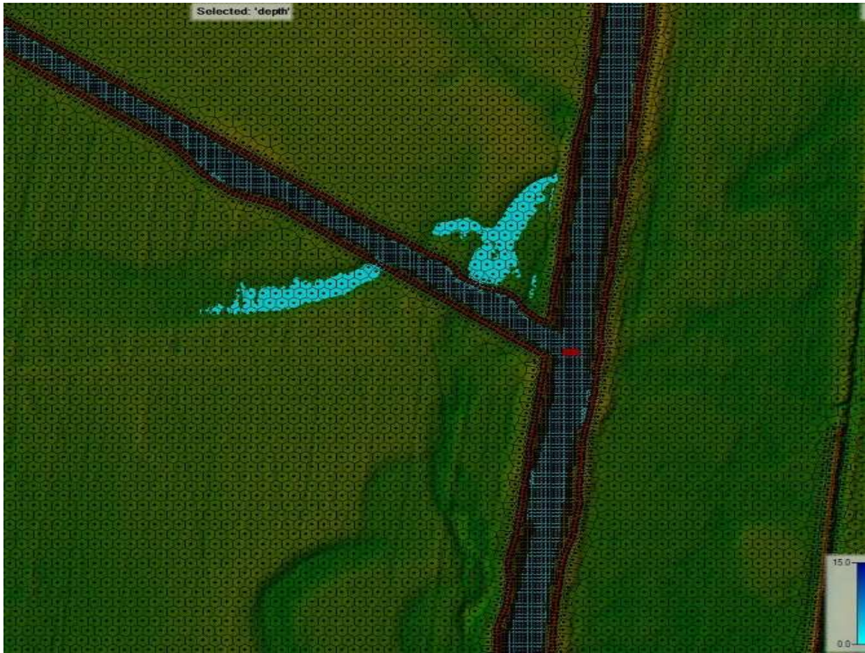
20. ábra Végeges HEC-RAS 2D modell geometriai kialakítás a Babócsai-Rinya vízfolyás esetében. A főmeder, és a töltésezett betorkolló vízfolyások medrek esetében területi rácsháló sűrítést alkalmaztunk. A magasponatok geometriába építésével sikeresen integráltuk a vízterelők elöntésre gyakorolt hatását a modellekbe. A meder esetében négyszög, az ártér esetében hatszög alakú rácshálót hoztunk létre.
