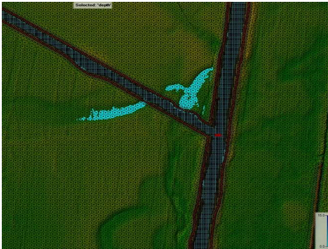
22. ábra Végeges HEC-RAS 2D modell geometriai kialakítás a Babócsai-Rinya vízfolyás esetében. A főmeder, és a töltésezett betorkolló vízfolyások medrek esetében területi rácsháló sűrítést alkalmaztunk. A magaspontok geometriába építésével sikeresen integráltuk a vízterelőkhöz gyakorolt hatásukat a modellekbe. A meder esetében négyszög, az ártér esetében hatszög alakú rácshálót hoztunk létre.
