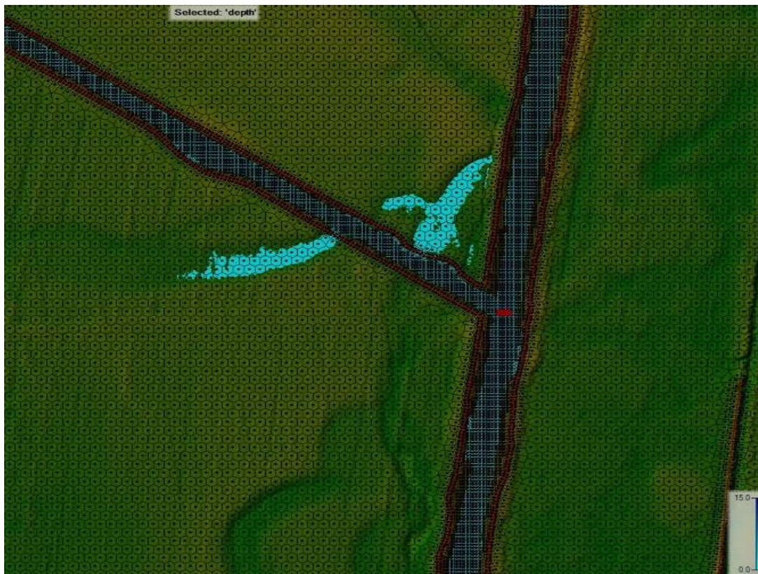
21. ábra Végeges HEC-RAS 2D modell geometriai kialakítás a Babócsai-Rinya vízfolyás esetében. A főmeder, és a töltésezett betorkolló vízfolyások medrek esetében területi rácsháló sűrítést alkalmaztunk. A magaspontok geometriába építésével sikeresen integráltuk a vízterelők elöntésre gyakorolt hatását a modellekbe. A meder esetében négyszög, az ártér esetében hatszög alakú rácshálót hoztunk létre.
